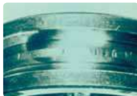
Etap 3: Po oderwaniu od powierzchni cząstekach materiału przetaczają się elementy toczne i pojawia się prawdziwe łuszczenie.
