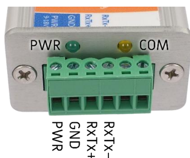
obr. 5 – Konektor pro napájení a RS485 u GNOME485 ISOL
