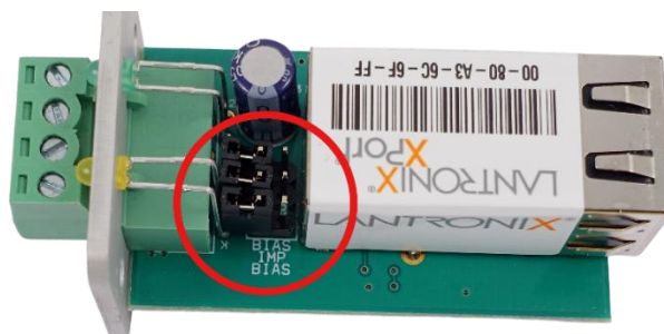
obr. 4 – jumpery BIAS a IMP uvnitř zařízení
