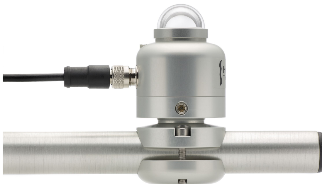
Rysunek 0.2 Po lewej cyfrowy pyranometr klasy drugiej SR05 z poziomnicą bąbelkową i złączem kabla M12 -A w konfiguracji standardowej (standardowo dołączony 3-metrowy kabel); po prawej SR05 z opcjonalnym poziomowaniem kulowym, do łatwego montażu i poziomowania na powierzchniach (po)ziomych (nie pokazano dołączonych śrub montażowych)
