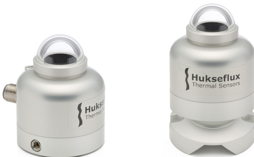
Rysunek 0.2 Po lewej cyfrowy pyranometr klasy drugiej SR05 z poziomnicą bąbelkową i złączem kabla M12 -A w konfiguracji standardowej (standardowo dołączony 3-metrowy kabel); po prawej SR05 z opcjonalnym poziomowaniem kulowym, do łatwego montażu i poziomowania na powierzchniach (po)ziomych (nie pokazano dołączonych śrub montażowych)
