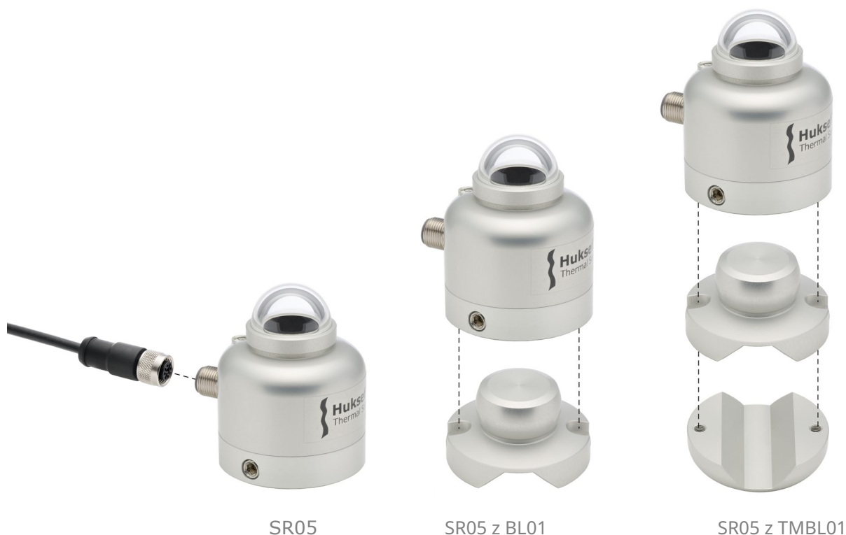
Rysunek 5.2.1 Od lewej do prawej: SR05 w standardowej konfiguracji z 3-metrowym kablem; z opcjonalnym poziomowaniem kulowym dla łatwego montażu i poziomowania na powierzchni (nie)poziomej; z opcjonalnym poziomowaniem kulowym i mocowaniem rurowym dla łatwej instalacji na rurze o średnicy 25 do 40 mm. Śruby montażowe są dołączone do poziomowania kulowego i/lub mocowania rurowego.
