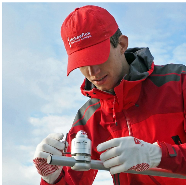
Rysunek 2: Łatwe poziomowanie SR05 na mocowaniu rurowym za pomocą poziomowania kulowego. Seria SR05 oferuje różne wyjścia cyfrowe i analogowe zgodne ze standardami przemysłowymi
