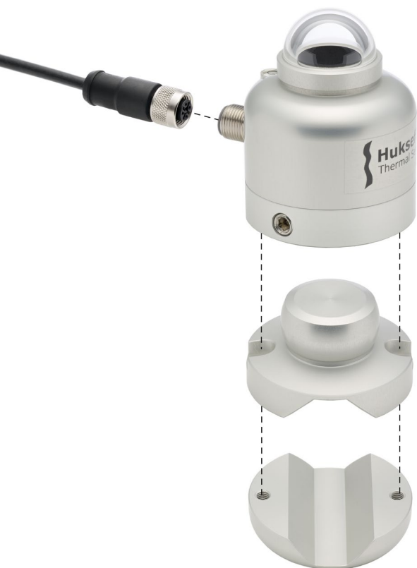
Rysunek 3 'Widok rozłożony' SR05. Opcjonalne poziomowanie kulowe i uchwyt rurowy umożliwiają łatwą instalację. Przewód (standardowo 3 m) wyposażony jest w złącze M12-A.
