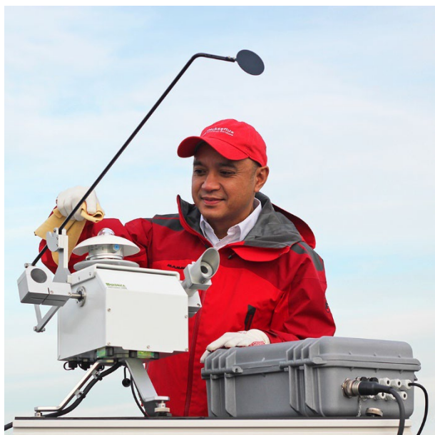
Rysunek 5 Tradycyjne rozwiązanie pomiaru promieniowania słonecznego rozproszonego i bezpośredniego: zautomatyzowany, napędzany silnikowo dwuosiowy tracker słoneczny wyposażony w pirneliometr i zacieniony pyranometr. SRD100 oferuje niskoobuługowe i bardziej niezawodne rozwiązanie (bez części ruchomych).
