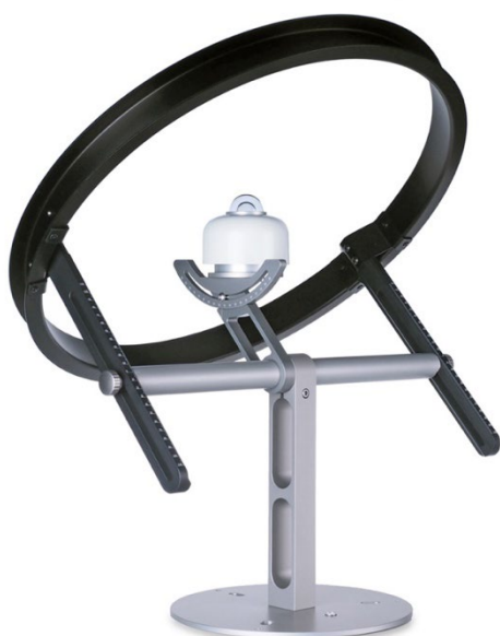
Rysunek 4. Tradycyjna metoda pomiaru promieniowania rozproszonego z wykorzystaniem pyranometru z pierścieniem cieniującym. SRD100 – rozwiązanie o minimalnych wymaganiach konserwacyjnych.
