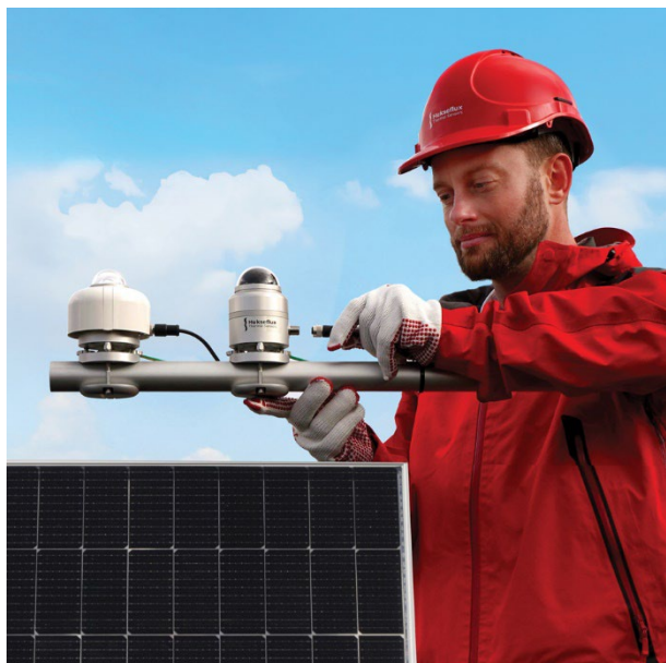
Rysunek 3. Typowa instalacja SRD100 obok standardowego pyranometru klasy A, np. SR300-D1.
