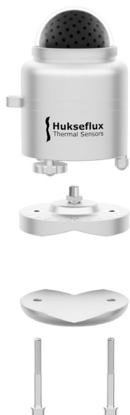
Rysunek 6: Opcjonalny sprężynowy uchwyt montażowy LM01 (jeden element) oraz uchwyt rurowy TLM01 (dwa elementy) dla SRD100. Sprężynowe poziomowanie znacząco skraca czas instalacji.
