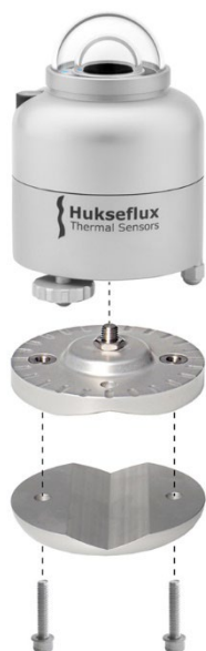
Rysunek 5 Opcjonalny montaż z mechanizmem sprężynowym do poziomowania i mocowania rurowego dla modeli SR300-D1, SR200-D1 oraz SR100-D1. Uchwyt poziomujący LM01 (jeden element), mocowanie rurowe TLM01 (dwa elementy). Poziomowanie ze sprężyną znacząco skraca czas instalacji.
