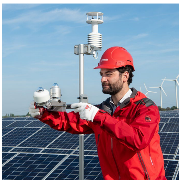
Rysunek 2 Dwa pyranometry SR300-D1, jeden pochylony do pomiaru natężenia promieniowania w płaszczyźnie modułów (POA), drugi zamontowany poziomo do pomiaru całkowitego natężenia promieniowania (GHI)
