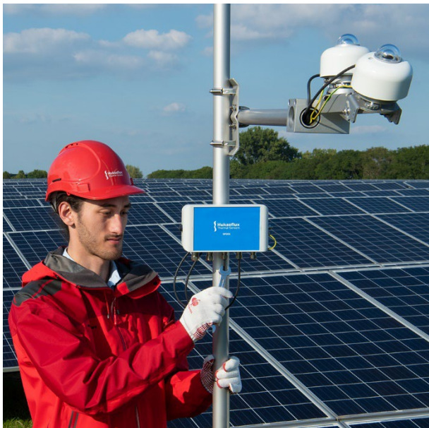
Rysunek 7 Dwa pyranometry SR300-D1 podłączone do urządzenia ochrony przeciwprzepięciowej SPD01. Opcjonalne urządzenie SPD01 pozwala podnieść odporność na przepięcia do poziomu 4
