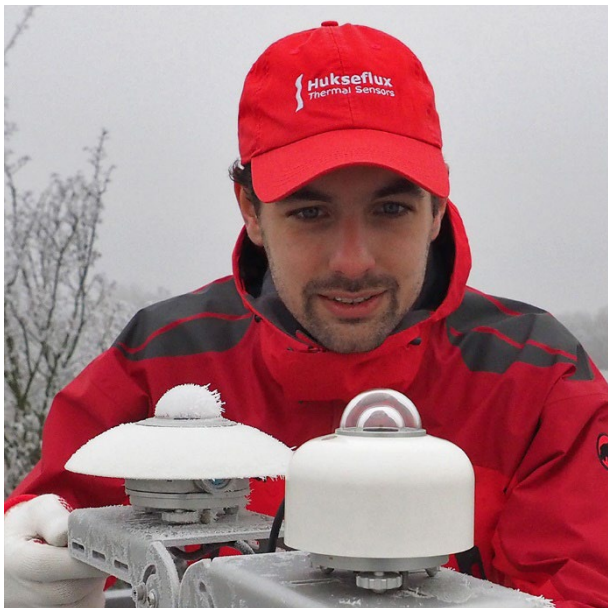
Rysunek 5 Ogrzewanie kontra rosa i szron: wyraźna różnica między pyranometrem ogrzewanym i nieogrzewanym
