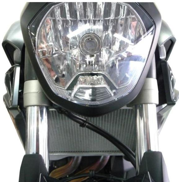
Montage conforme : écopes alignées
