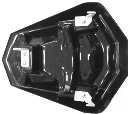
Avant d'effectuer le serrage définitif, présenter le capot de selle sur la moto et le centrer (jouer sur la position des agrafes si nécessaire). Le démonter et serrer les vis de manière à bloquer le positionnement des pattes.
