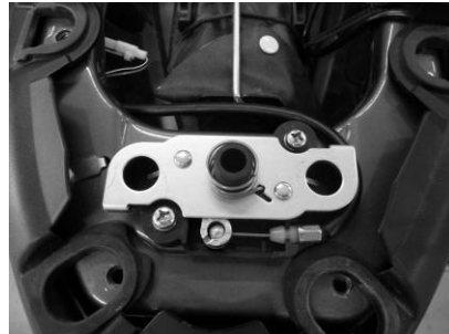
2° Position du système de verrouillage de selle
