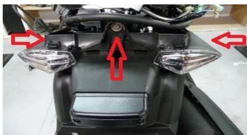
Emplacement des 3 vis de fixation bavette
