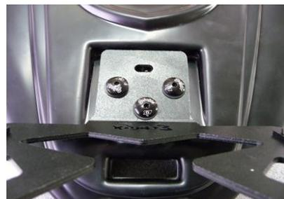
Positionnement des rondelles, des écrous frein et de la vis 5x25 petite tête.
