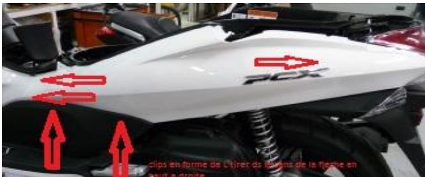
Emplacement des clips : tirer dans le sens de la flèche en haut à droite pour sortir la coque
