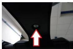
Vis cruciforme de la bavette
