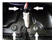
Vis de maintien de la bavette arrière
